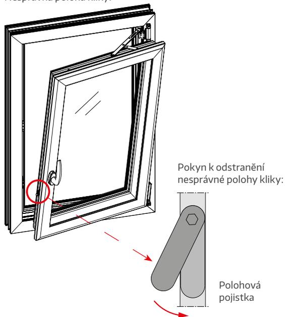
Dojde-li i přes přítomnost polohovací pojistky k nastavení nesprávné polohy kliky, postupujte podle následujících pokynů:
